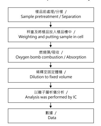
鹵素分析流程圖 / Analytical flow chart - Halogen
