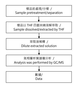
【測試方法/Test method: IEC 62321-8】
