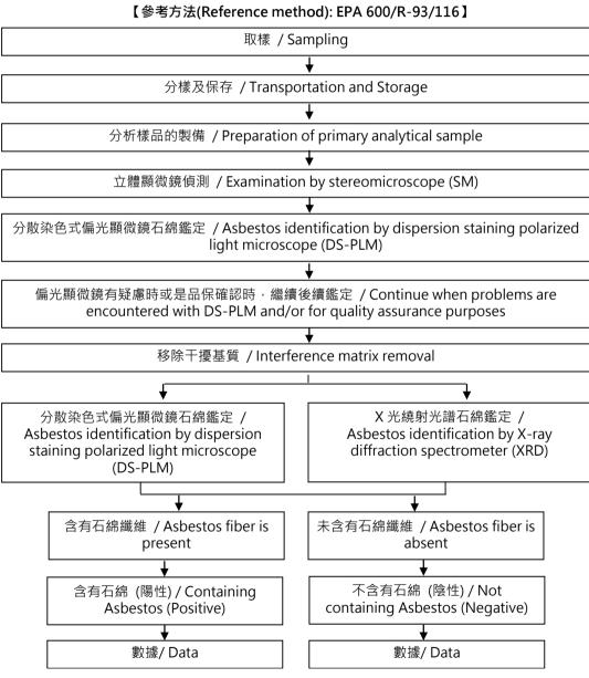
石綿鑑定分析流程圖 / Analysis flow chart for determination of Asbestos
