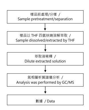
【測試方法/Test method: IEC 62321-8】
